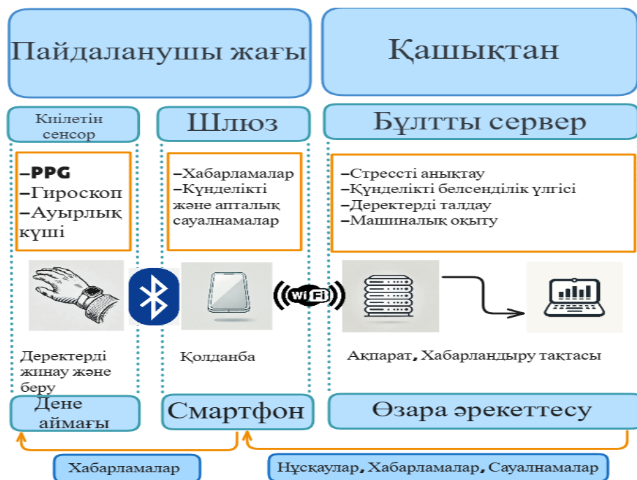
Сурет 5. Күнделікті жағдайда стрессті бақылауға арналған жүйесі
