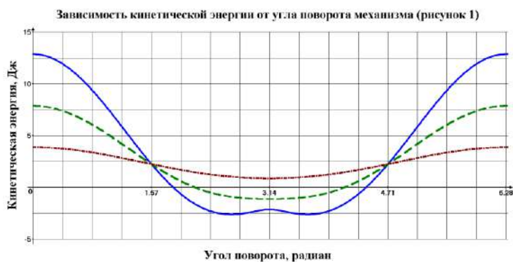
Рисунок 3. График зависимости кинетической энергии эксцентрисеской массы сателлита от угла поворота водило
