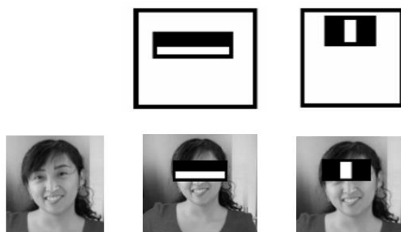
Рисунок 1. Различные этапы визуализации классификатора Хаара
