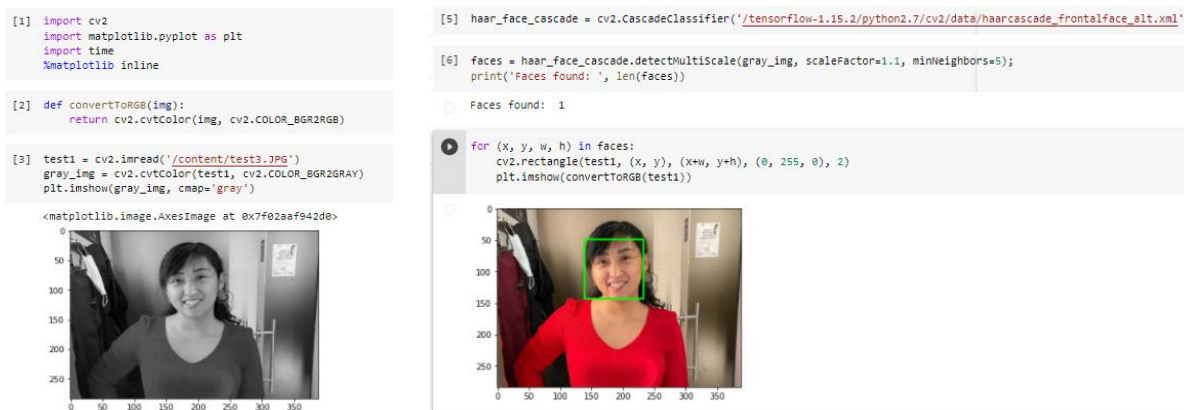
Рисунок 2. Распознавание с классификатором Хаара в OpenCV
