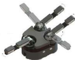
Сурет 3. Еркіндік дәрежесі 10-ға тең үш буынды қармау саусақтары
