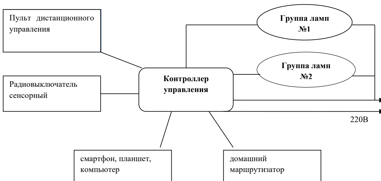
Рисунок 3. Схема управления освещением «умного дома» при помощи контроллера Arduino
