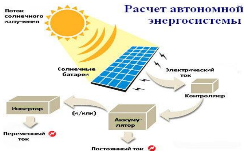
Рисунок 1. Схема работы автономной системы энергоснабжения
