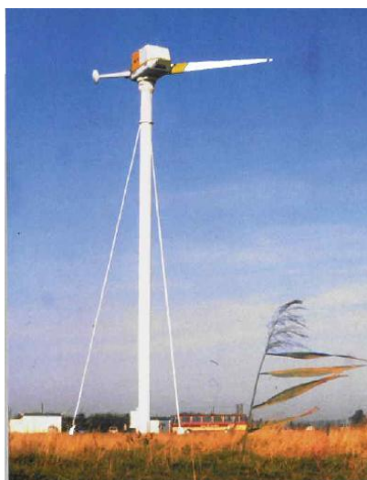
Рисунок 3. Однолопастная пропеллерная турбина
