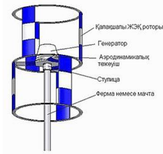
Сурет 3. Ортогональді (роторлі) жел қондырғысы
