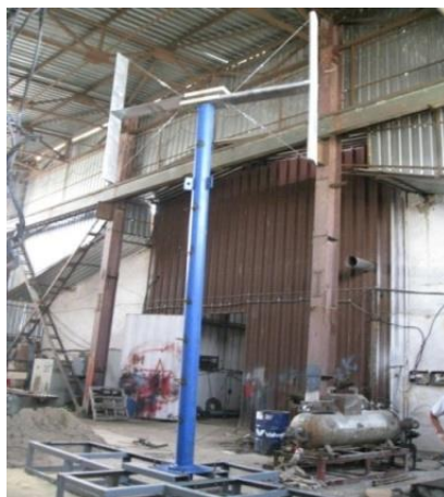
Рисунок 5. Комбинированная ветроустановка НВИ-ротор карусельного типа полупромышленного образца
