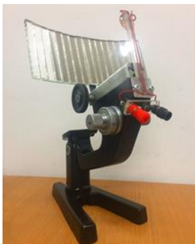
Рисунок 3 - Общий вид стенда концентратора излучения 1 - солнечный элемент; 2 – радиатор; 3 – державка; 4 – штатив: а) неподвижный элемент б) узел поворота по азимуту в) узел поворота по углу места; 5 – параболический зеркальный рефлектор; 6 – механизм наведения фокуса; 7 – клеммы для подключения солнечного элемента.
