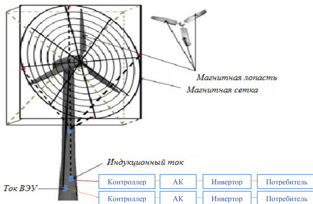
Рисунок 1. Общий вид ветрогенератора с магнитными лопастями
