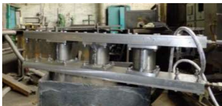
Рисунок 5 - Сборки для проведения гидравлических испытаний подводящих каналов и комплексных гидравлических испытаний
