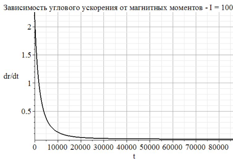
Рисунок 6 - График изменения углового ускорения спутника при постоянных магнитных моментах где масса и размер есть функции линейно зависящие от времени при внутреннем магнитном моменте I_0 = 100 \text{ A} \cdot \text{м}^2
