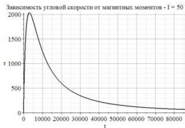
Рисунок 5 – График изменения угловой скорости спутника при постоянных магнитных моментах где масса и размер есть функции линейно зависящие от времени при внутреннем магнитном моменте I_0 = 50 \text{ A} \cdot \text{м}^2
