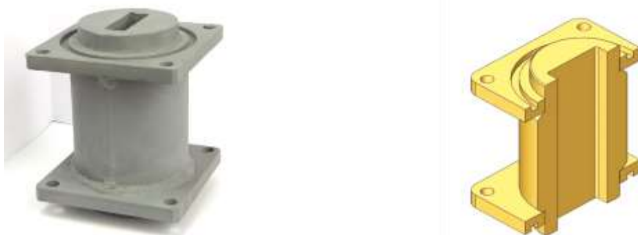
Рисунок 3. Диффузионный канал. Имеется набор диффузионных каналов с характерными размерами 8, 12, 16, 22 мм (изготовленный экземпляр и численная виртуальная модель)
