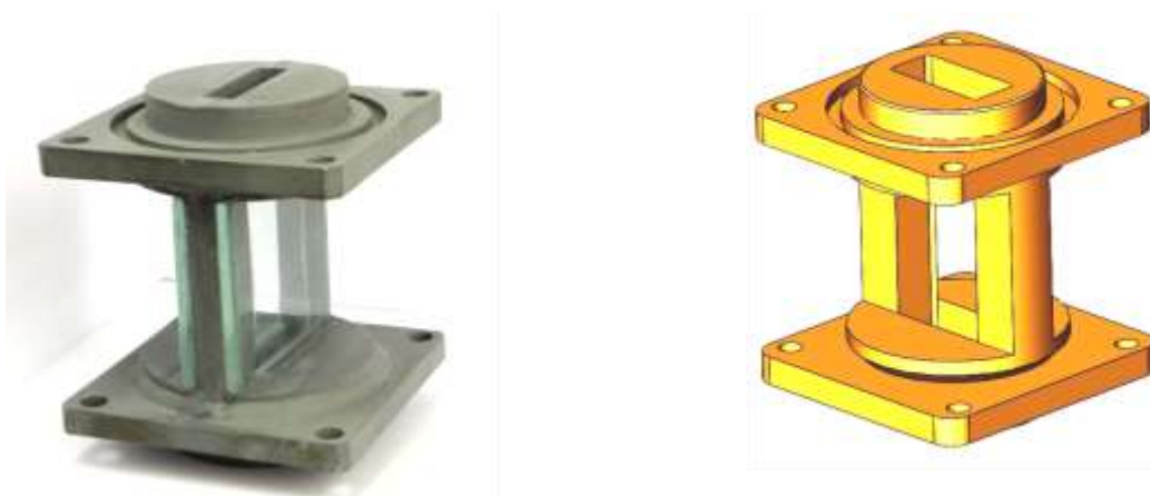
Рисунок 5. Диффузионный канал для изучения процессов в теновом приборе (изготовленный экземпляр и численная виртуальная модель)
