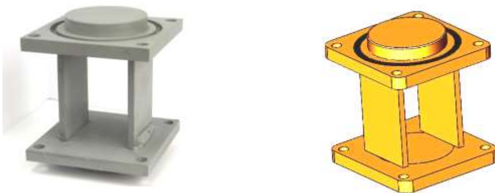
Рисунок 4. Имитатор диффузионного канала для сборок модуля с различным числом диффузионных каналов (изготовленный экземпляр и численная виртуальная модель).
