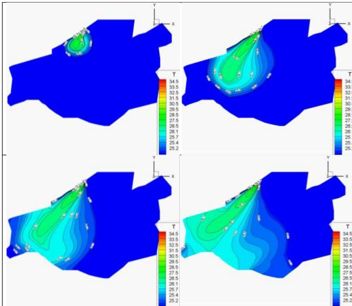
Рис. 3. Контур и изолиний распределения температуры через 1, 5, 10 и 24 ч. после старта работы ГРЭС-1, на поверхности воды для эксплуатационной мощности 1200 МВт.
