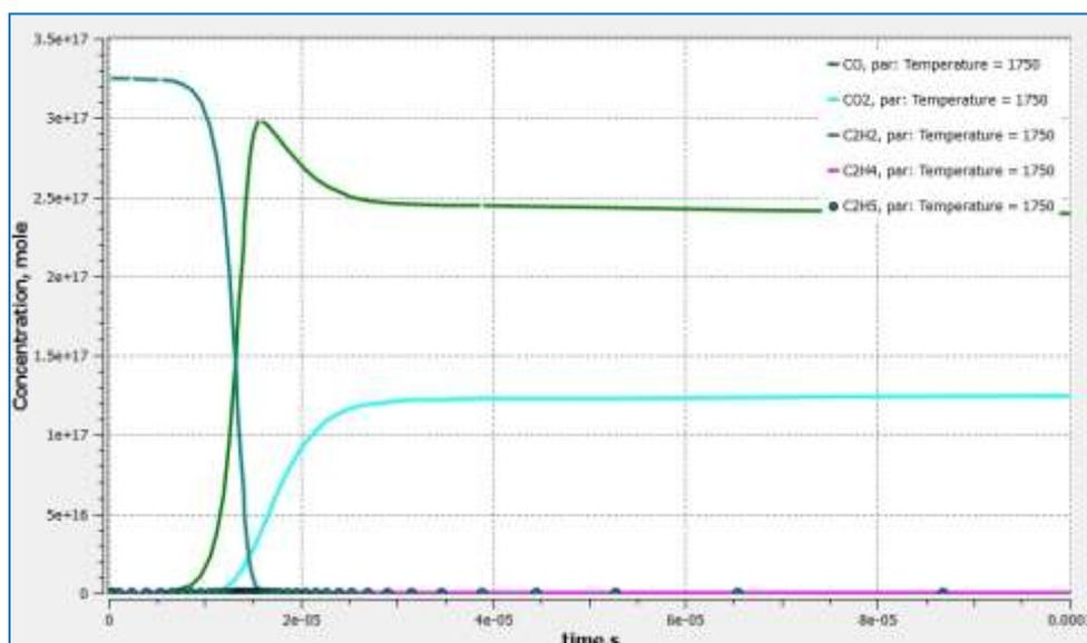
Рисунок 7. Концентрация вредных веществ, возникших при горении ( $\text{CO}$ ,  $\text{CO}_2$ ,  $\text{C}_2\text{H}_2$ ,  $\text{C}_2\text{H}_4$ ,  $\text{C}_2\text{H}_5$ )
