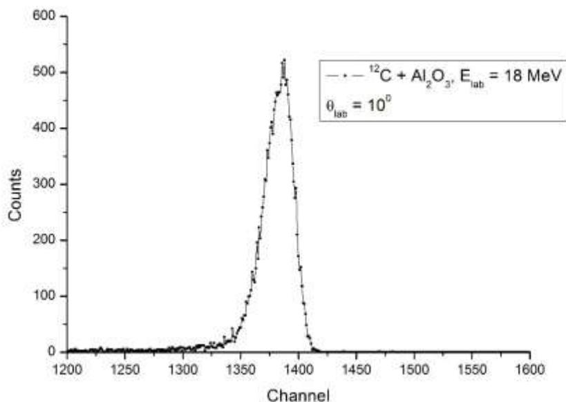
Рис. 1. Упругое рассеяние ионов углерода  $^{12}\text{C}$  на ядрах  $^{16}\text{O}$ ,  $^{27}\text{Al}$  при угле в 10 градусов в лабораторной системе.
