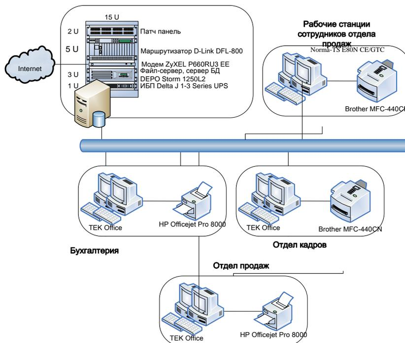
Рисунок 3 - Физическая схема локальной сети ТОО
