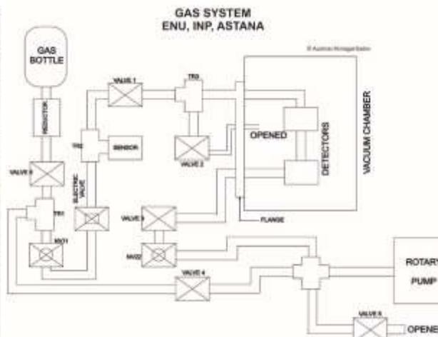
Рис. 3. Блок-схема газонаполнительной системы для регистрации заряженных частиц на ускорителе ДЦ-60
