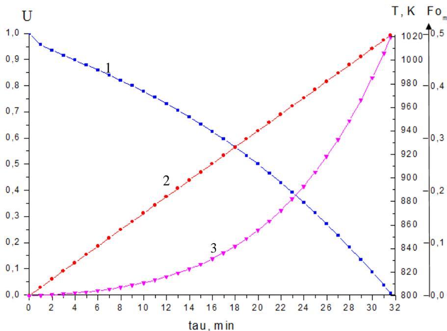
3-сурет. Жазық керамикалық үлгідегі диффузиялық дегидратация үдерістерінің кинетикалық қисықтары  $d = 2r = 4\text{ см}$ ;  $Q = 7\text{ К/мин}$ .
