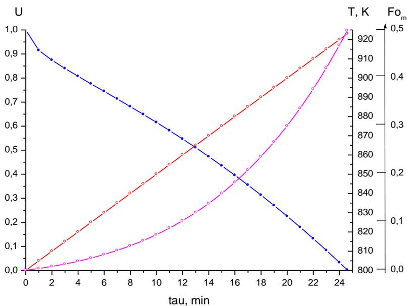
4-сурет. Жазық керамикалық үлгідегі диффузиялық дегидратация үдерістерінің кинетикалық қисықтары.  $d = 2r = 2\text{ см}$ ;  $Q = 5\text{ К/мин}$ .
