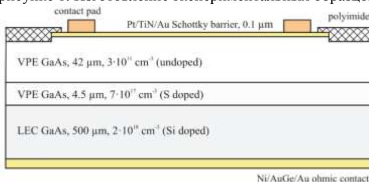
Рисунок 1. Принципиальная конструкция поверхностно-барьерного GaAs детектора
