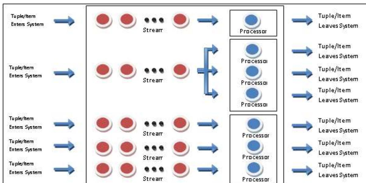
Рисунок 1. Типовые конфигурации систем очередей
