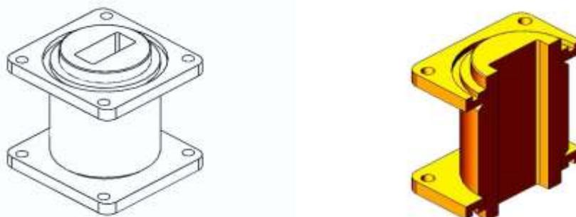
Рисунок 2 – Диффузионный канал. Имеется набор диффузионных каналов с характерными размерами 8, 12, 16, 22 мм.
