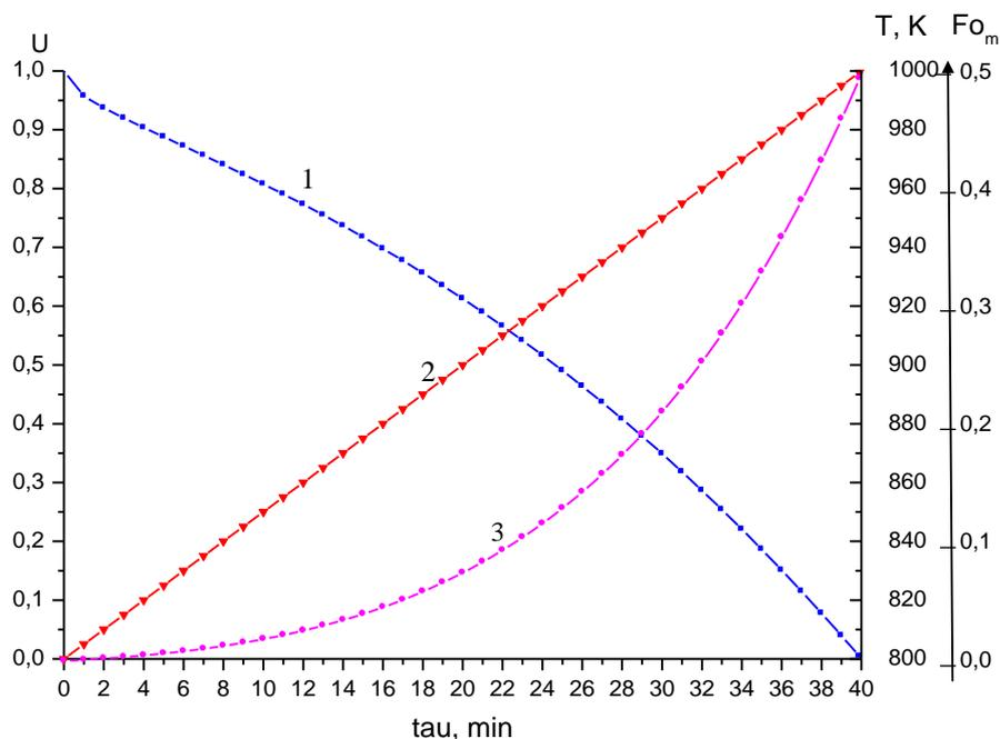
2-сурет. Жазық керамикалық үлгідегі диффузиялық дегидратация үдерістерінің кинетикалық қисықтары  $d = 2r = 4\text{см}$ ;  $\mathcal{Q} = 5\text{К} / \text{мин}$ .
