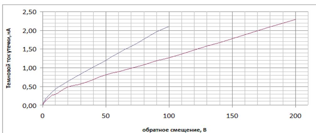
Рисунок 3. Электрические характеристики детектора
