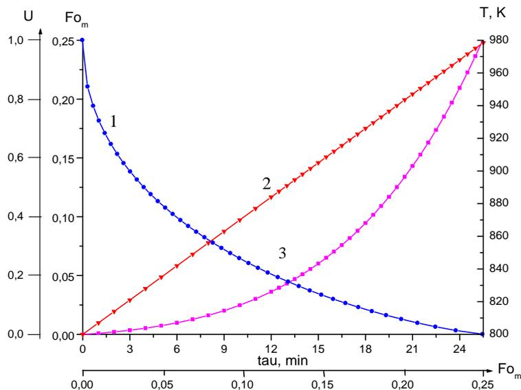
3-сурет. Цилиндрлік керамикалық үлгілердегі изотермиялық емес жағдайдағы дегидратация кезіндегі диффузиялық үдерістердің кинетикалық қисықтары.
