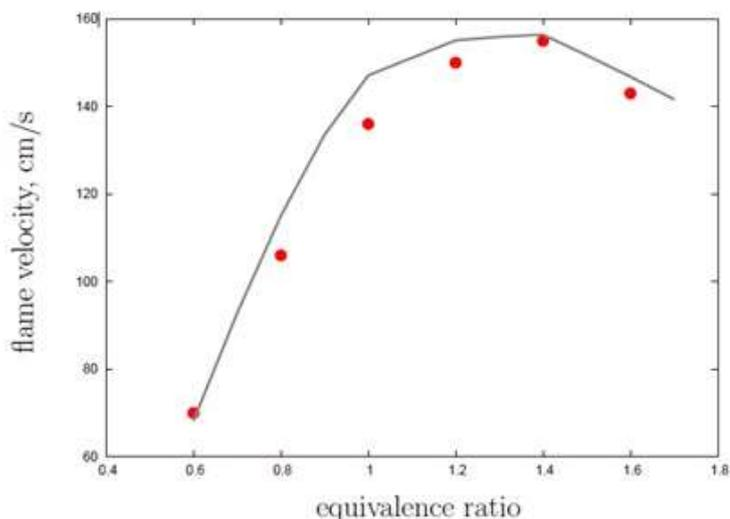
Рисунок 1. Скорость пламени горения смеси ацетилен – воздух (здесь линия – показывает модель, точка – экспериментные данные).
