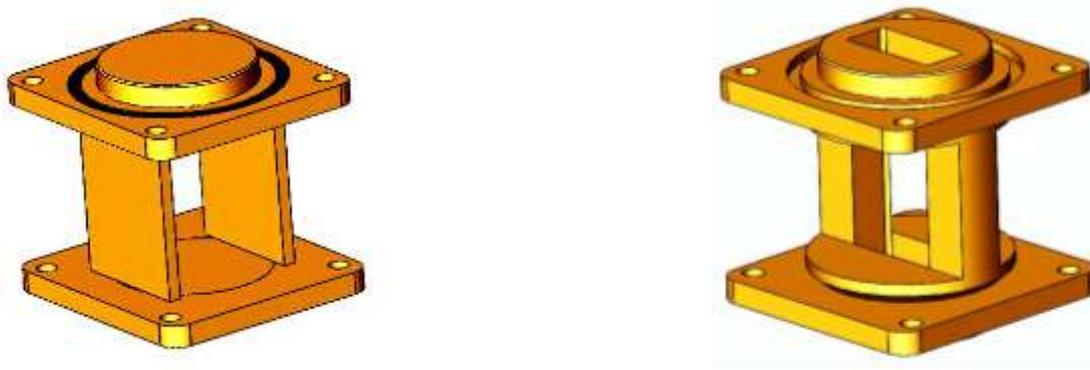
Рисунок 3 – Имитатор диффузионного канала и диффузионный канал с прозрачным окном для изучения процессов в теновом приборе.
