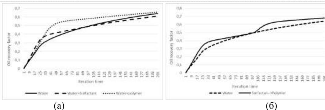
Рисунок 9 – Коэффициент нефтеотдачи пласта для а) закачка воды, раствора ПАВ и раствора полимера по отдельности; б) комбинированное заводнение.
