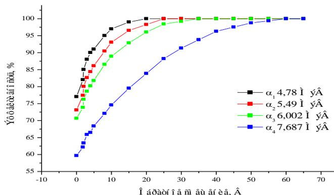
Рисунок 4 – Эффективность сбора заряда на  $\alpha$ -частицах от источника  $^{226}\text{Ra}$ , оцененная по центрам тяжестей распределений при различных смещениях на детекторе
