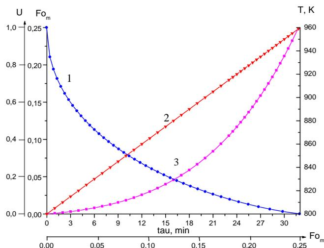
2- сурет. Цилиндрлік керамикалық үлгілердегі изотермиялық емес жағдайдағы дегидратация кезіндегі диффузиялық үдерістердің кинетикалық қисықтары.
