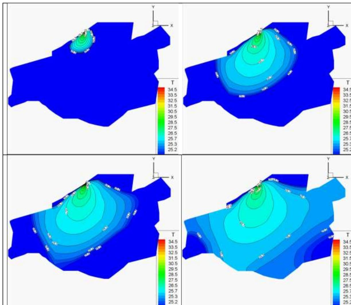
Рис. 2. Контур и изолиний распределения температуры через 1, 5, 10 и 24 ч. после старта работы ГРЭС-1, на поверхности воды для эксплуатационной мощности 200 МВт.
