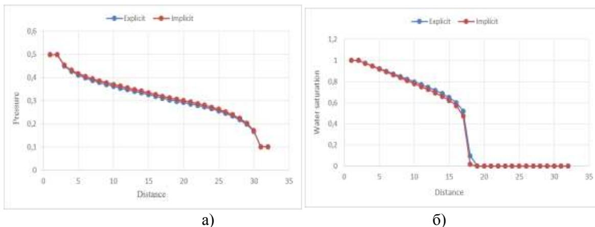
Рисунок 2 – Распределение (а) – давления и (б) – насыщенности воды
