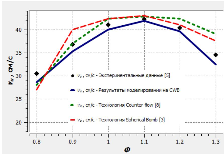
Рисунок 2 – Зависимость скорости распространения пламени от стехиометрии смеси.
