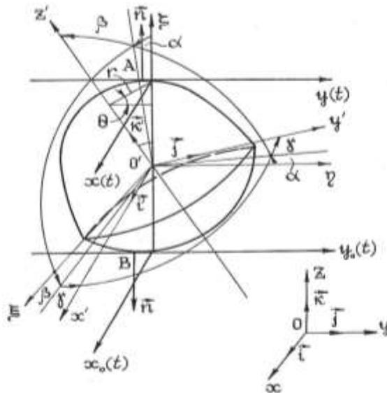
Рисунок 2 – Система координат для описания двумерного движения тела качения
