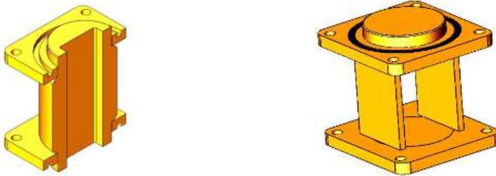
Рисунок 4 – Диффузионный канал и имитатор диффузионного канала. Имеется набор диффузионных каналов с характерными размерами 8, 12, 16, 22 мм.
