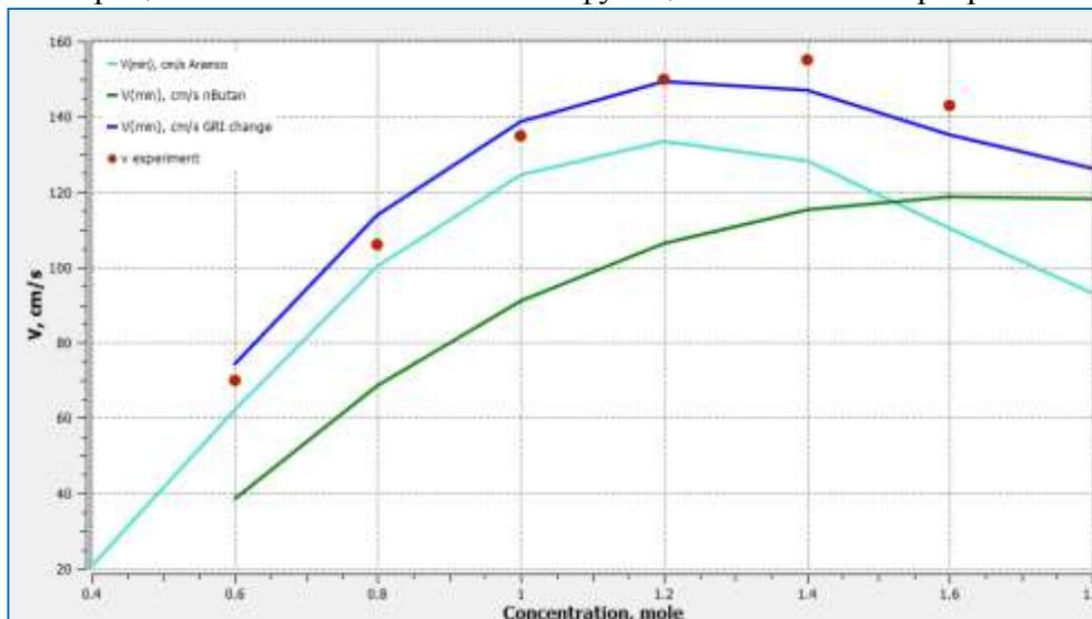
Рисунок 4. Скорость горения ацетилена в воздухе при различных концентрациях.  $T = 298$  К,  $p = 1$  бар (голубой - Saudi Aramco 1.3 Mechanism, зелёный - n-Butane/oxygen/argon Mechanism, синий - GRI- 3.0 Acetylen – Air, точка – эксперимент)
