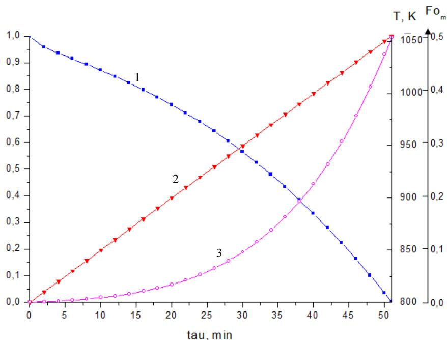
5-сурет. Жазық керамикалық үлгідегі диффузиялық дегидратация үдерістерінің кинетикалық қисықтары  $d = 2r = 6\text{ см}$ ;  $\mathcal{Q} = 5\text{ К} / \text{мин}$ .
