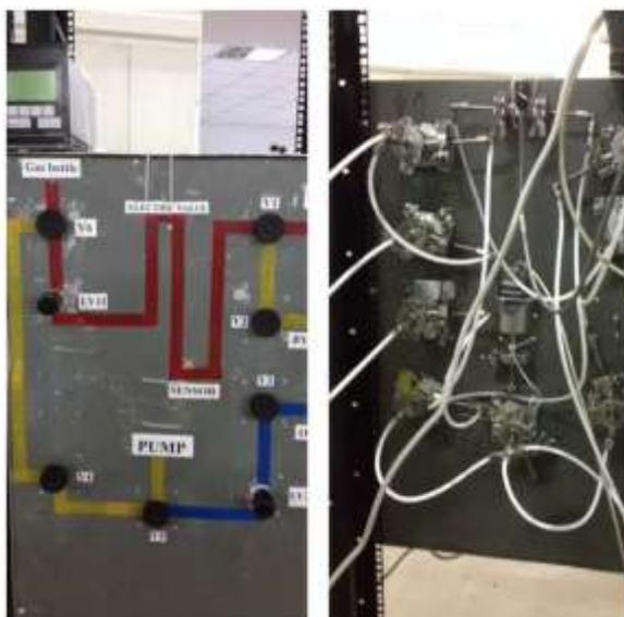
Рис. 2. Слева - фронтальный вид, справа - вид сзади газонаполнительной системы для регистрации заряженных частиц на ускорителе ДЦ-60..
