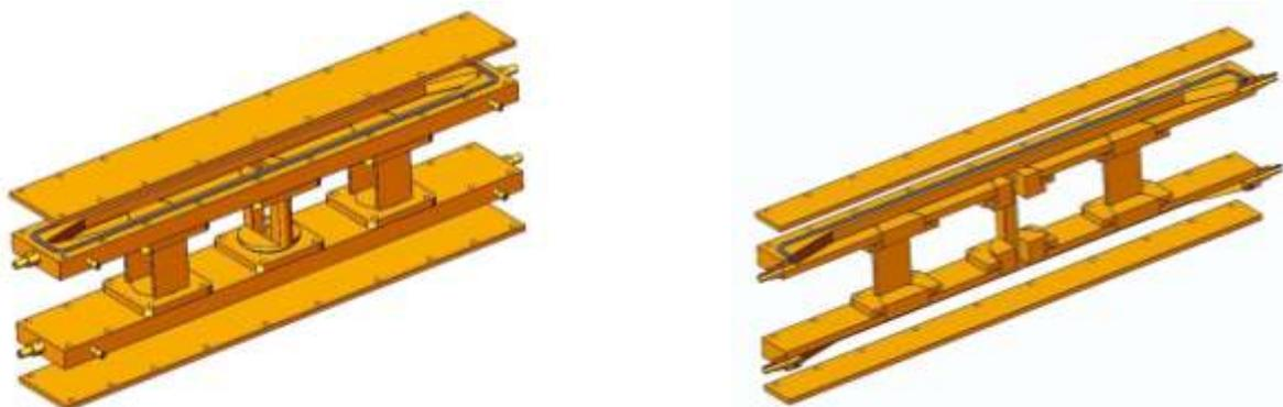
Рисунок 4 – Экспериментальное устройство по разделению газов содержащих углеводородные компоненты. Сборка для изучения процессов в диффузионном канале на теновом приборе.
