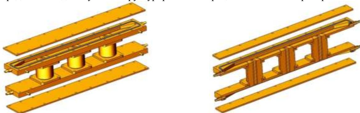
Рисунок 1– Экспериментальное устройство по разделению газов содержащих углеводородные компоненты. Сборка для изучения зависимости коэффициентов разделения от сечений диффузионных каналов.
