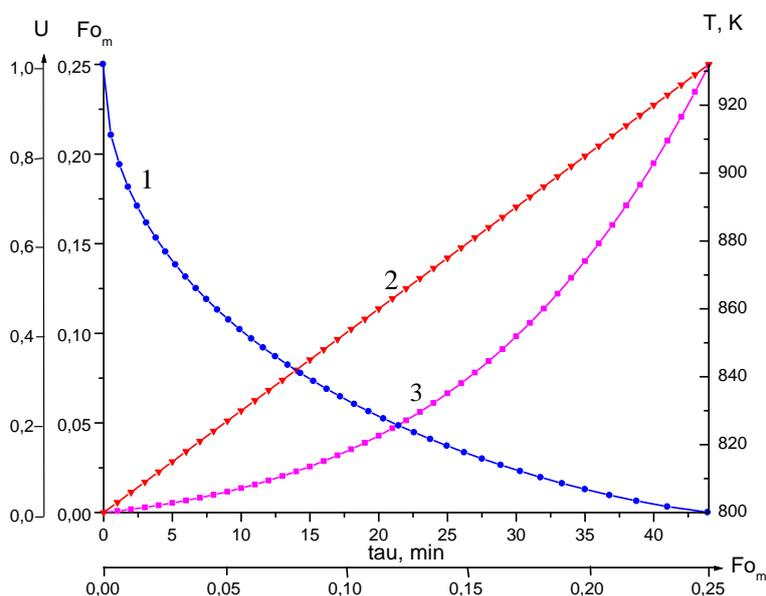
1-сурет. Цилиндрлік керамикалық үлгілердегі изотермиялық емес жағдайдағы дегидратация кезіндегі диффузиялық үдерістердің кинетикалық қисықтары.
