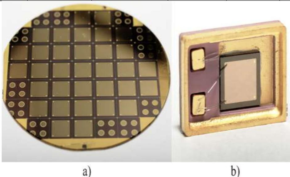
Рисунок 2. Фотография поверхностно-барьерного GaAs детектора: а) двухдюймовая GaAs подложка со сформированными структурами и б) детектор в корпусе (размер чипа  $6 \times 6$  мм<sup>2</sup>, размер активной области  $5 \times 5$  мм<sup>2</sup>).
