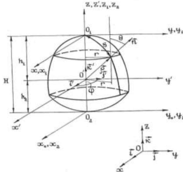
Рисунок 1 – Система координат для описания движения тела вращения
