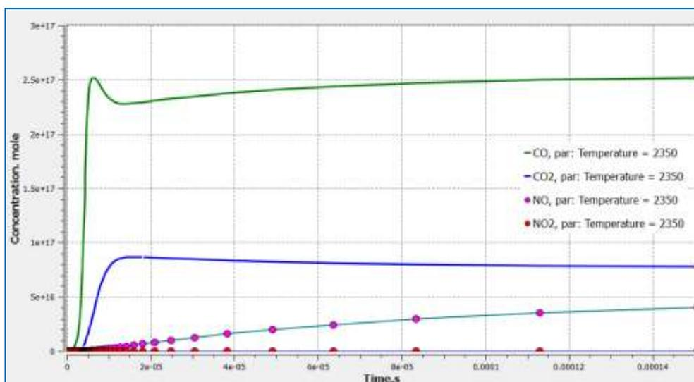
Рисунок 8. Концентрация вредных веществ, возникших при горении ( $\text{CO}$ ,  $\text{CO}_2$ ,  $\text{NO}$ ,  $\text{NO}_2$ ,  $T = 2350 \text{ K}$ ,  $\rho = 1 \text{ ат}$ )
