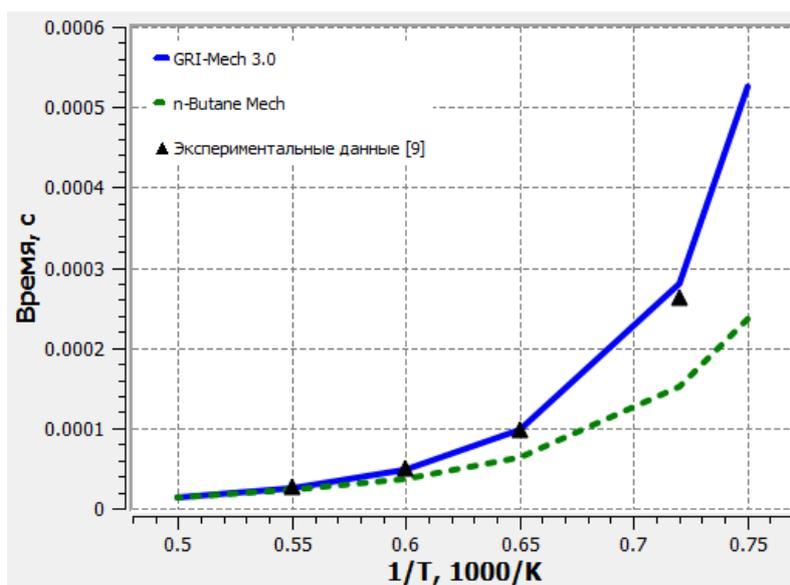
Рисунок 3 – Зависимость времени воспламенения смеси от начальной температуры.
