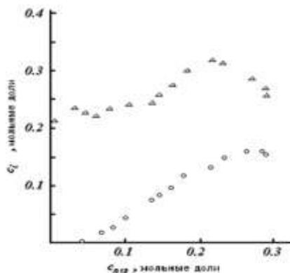
Рисунок 1 – Селективное разделение фреона-12 в зависимости от его содержания в исходной газовой смеси  $He + R12 - Ar$ . Точки  $\circ$ ,  $\Delta$  – опытные данные для фреона-12 и гелия.  $P = 0,092$  МПа,  $T = 298,0$  К [8,9].
