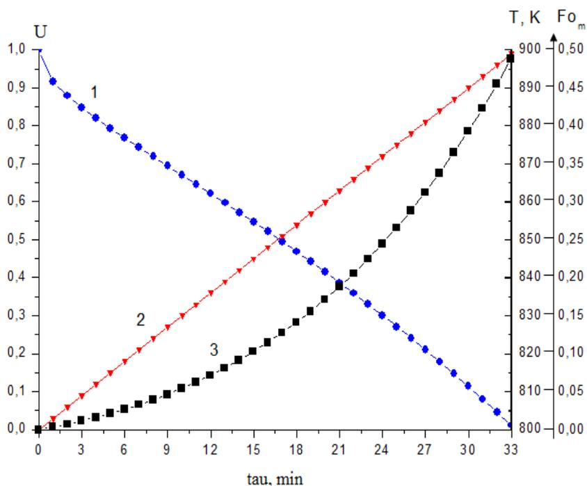
1-сурет. Жазық керамикалық үлгідегі диффузиялық дегидратация үдерістерінің кинетикалық қисықтары  $d = 2r = 4\text{см}$ ;  $\mathcal{Q} = 3\text{К} / \text{мин}$ .
