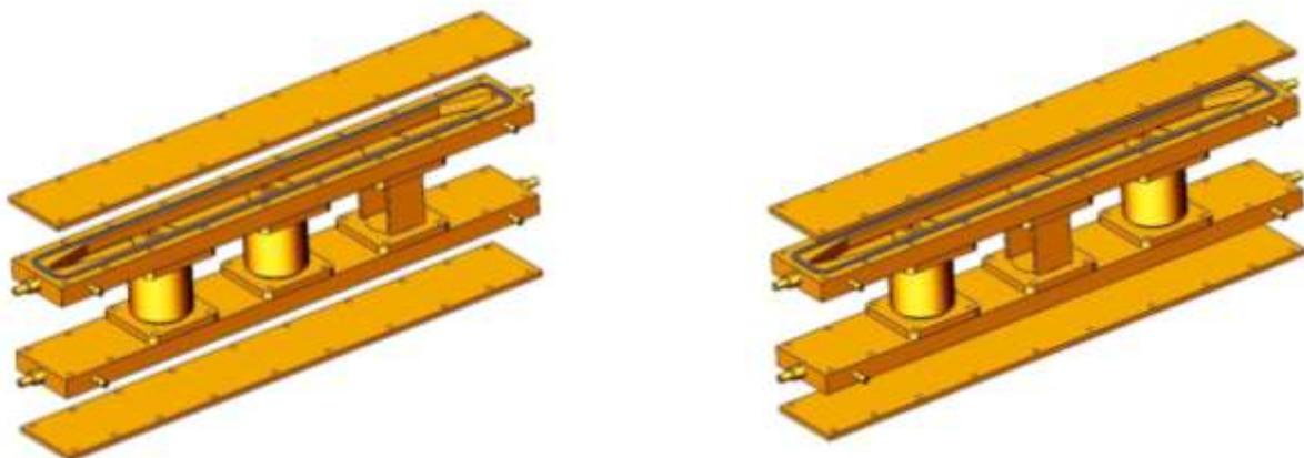
Рисунок 5 – Экспериментальное устройство по разделению газов содержащих углеводородные компоненты. Сборки для изучения зависимости коэффициентов разделения от расстояния между диффузионными каналами.
