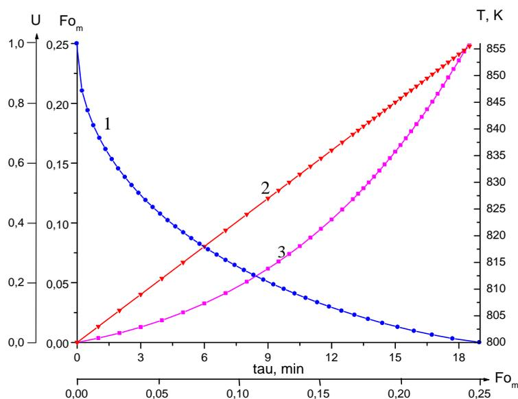
4 – сурет. Цилиндрлік керамикалық үлгілердегі изотермиялық емес жағдайдағы дегидратация кезіндегі диффузиялық үдерістердің кинетикалық қисықтары.
