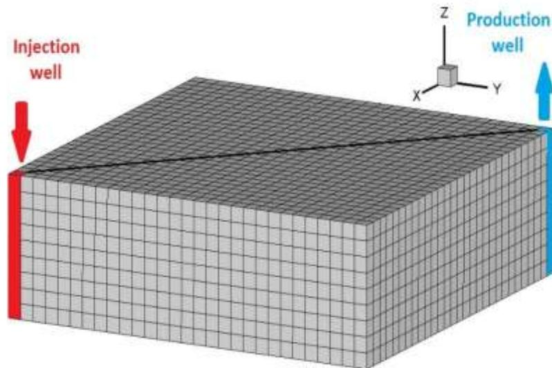
Рисунок 1 – расположение скважин на расчетной сетке
