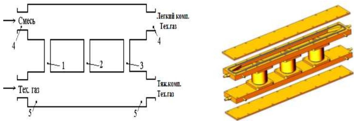
Рисунок 2 – Схема и внешний вид устройства для разделения газов в режиме диффузионной неустойчивости. 1, 2, 3 – диффузионные каналы, 4 – канал углеводородных газов, 5 – канал технического (буферного) газа.
