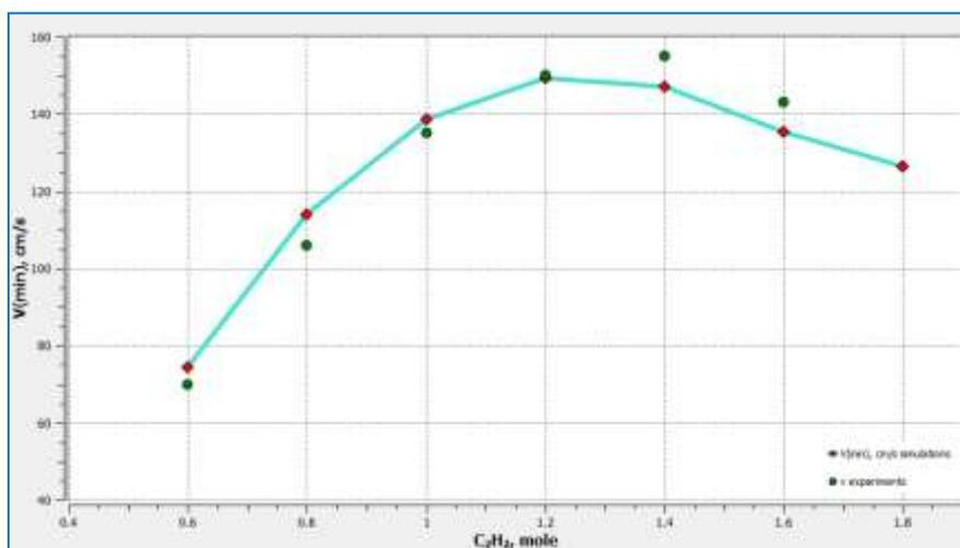
Рисунок 2. Скорость пламени горения смеси ацетилен – воздух. (здесь линия – показывает моделирование с собранным механизмом, точка – экспериментальные данные, взятые из [3])
