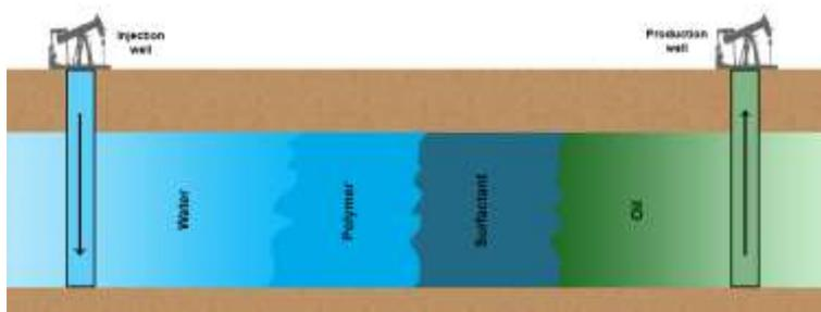
Рисунок 8 – Последовательность закачки химических реагентов
