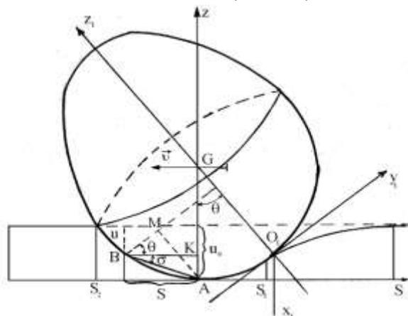
Рисунок 1 – Схема опоры качения деформированными основаниями
