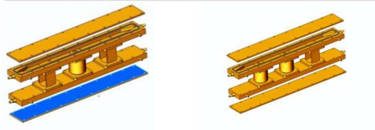
Рисунок 6 – Экспериментальное устройство по разделению газов содержащих углеводородные компоненты. Сборки для изучения зависимости коэффициентов разделения от количества диффузионных каналов.
