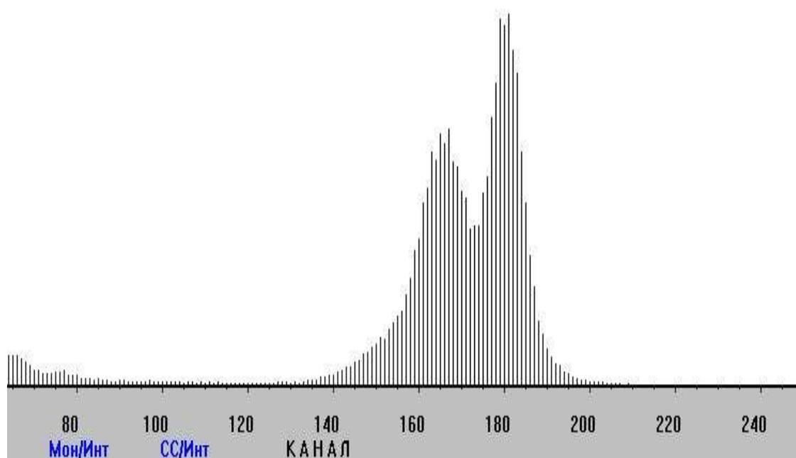
Рис. 4. Спектр, полученный газовым детектором на ускорителе ДЦ-60 по упругому рассеянию  $^{12}\text{C}$  на  $^{16}\text{O}$ ,  $^{27}\text{Al}$  при угле в 25 градусов.
