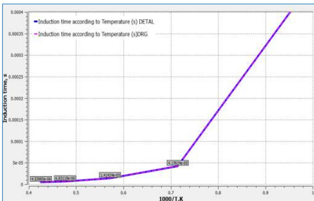
Рисунок 5. Зависимость времени индукции от температуры. (Полный и метод редуцирования DRG)
