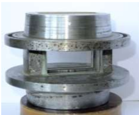
Рисунок 5 – Модуль диффузионного канала с оптически прозрачным окном для изучения конвективных течений методом Теплера[18]
