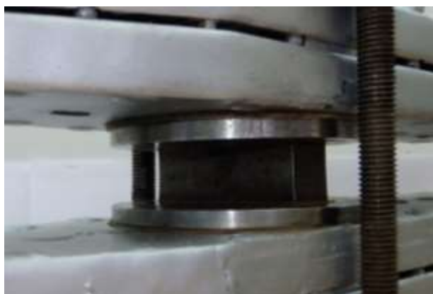
Рисунок 3 – Установка модуля диффузионного канала на устройстве для разделения газов в конвективном режиме
