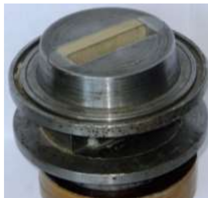
Рисунок 5 – Модуль диффузионного канала с оптически прозрачным окном для изучения конвективных течений методом Теплера[18]
