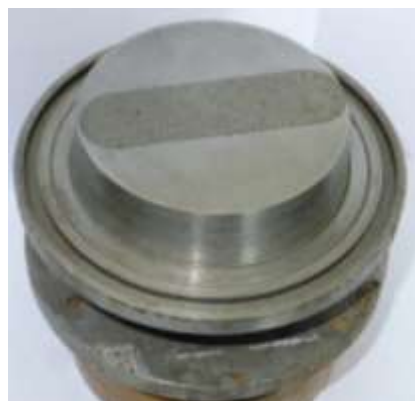
Рисунок 6 – Модули диффузионного канала с четырьмя цилиндрическими каналами и набором капилляров для изучения характерных особенностей конвективного массопереноса
