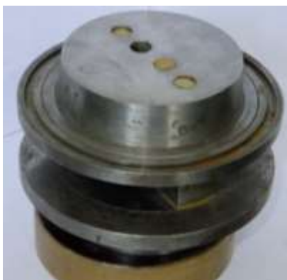
Рисунок 6 – Модули диффузионного канала с четырьмя цилиндрическими каналами и набором капилляров для изучения характерных особенностей конвективного массопереноса
