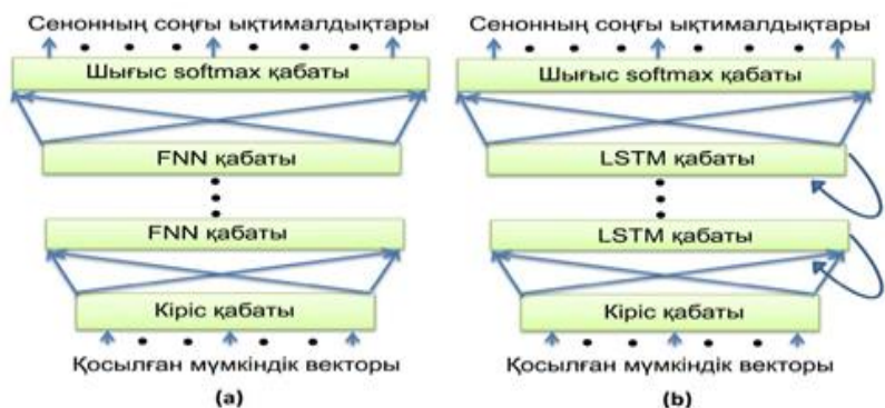
Сурет 3. (a) DFNN және (b) DLSTM көмегімен акустикалық модельдеуде қолданылатын желілердің топологиясы
