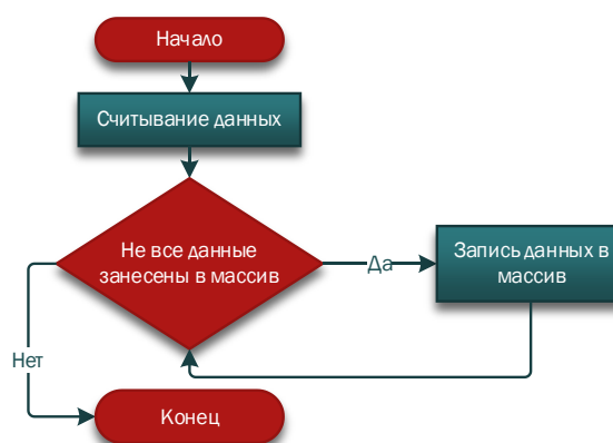
Рисунок 3. Блок-схема функции считывания данных
