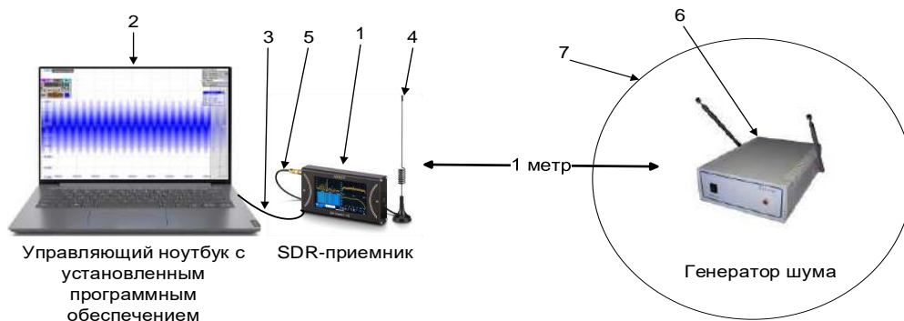
Рисунок 1. Мобильный аппаратно-программный комплекс оценки качества маскирующих шумовых помех
