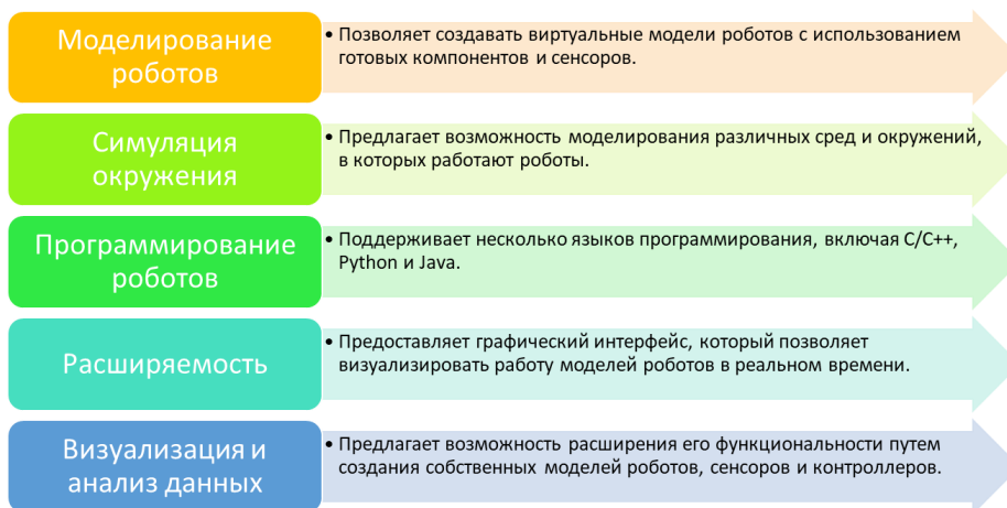
Рисунок 4. Возможности мультиплатформенной среды моделирования роботов Webots
