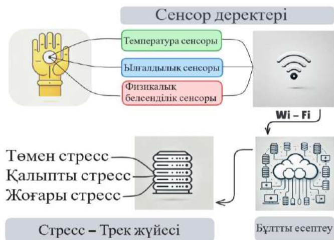
Сурет 7. Кеуде және білек датчиктерінен жиналған физиологиялық деректерді талдауға арналған терең нейрондық желі әдістері
