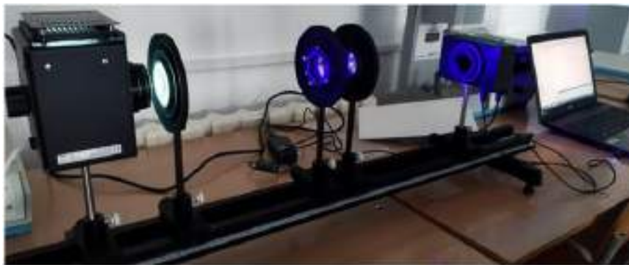
Сурет 1. Ньютон сақиналарын бақылауға арналған қондырғы
