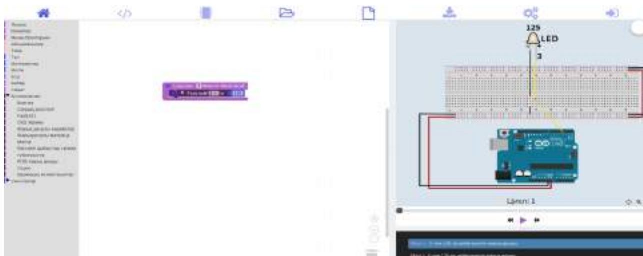
Сурет 4. Жарықдиод жұмысын PWM сигнал көмегімен басқару
