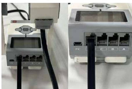
Сурет 8. Үлкен қозғалтқышты порттарға жалғау
