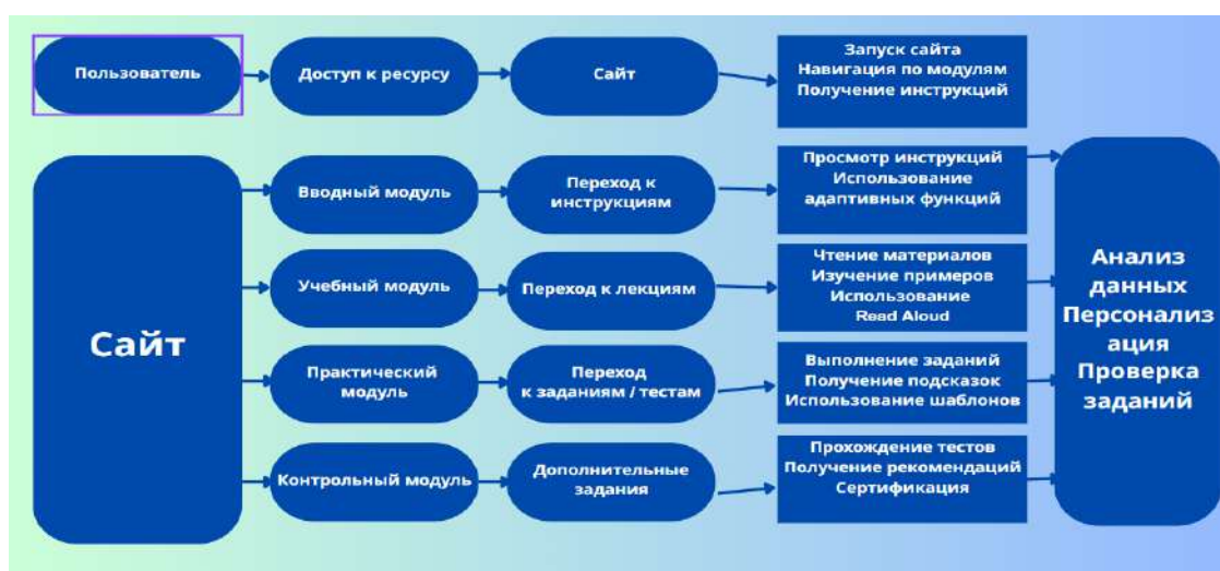
Рисунок 3. UML- схема архитектуры образовательного ресурса
