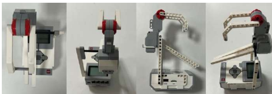
Сурет 3. Микропроцессорлық блокқа үлкен қозғалтқышты орнату
