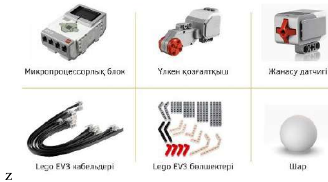
Сурет 1. «Теңүдемелі қозғалыс кезіндегі дененің үдеуін анықтау» зертханалық жұмысын жасауға қажетті құрал-жабдықтар
