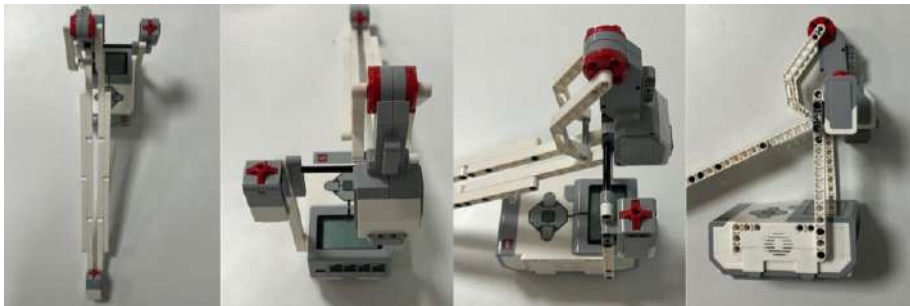
Сурет 6. Бөгеттің көтерілуіне әсер ететін жанасу датчигін орнату
